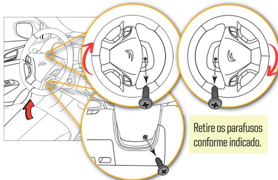
Retire os parafusos conforme indicado.
