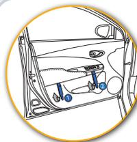
Remova o encosto de braço e o comando dos vidros utilizando uma espátula para não danificar o acabamento.
