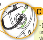
• Desconecte o sistema original fêmea do motor do vidro elétrico e conecte as duas partes ao sistema "Y" fornecido com o produto (Conector macho do motor do vidro elétrico com o fêmea do produto e vice-versa).
