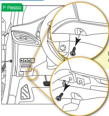
Retire os parafusos conforme indicado.
