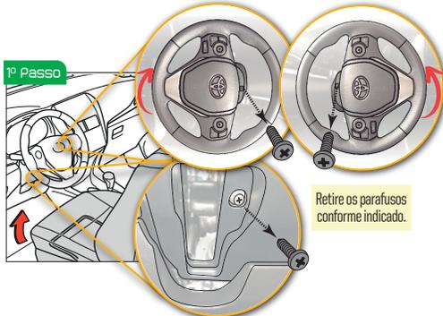
Retire os parafusos conforme indicado.
