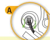
• Desconecte o sistema original fêmea da trava elétrica e conecte as duas partes ao sistema "Y" fornecido com o produto (Conector fêmea do chicote original com o macho do produto e vice-versa).
