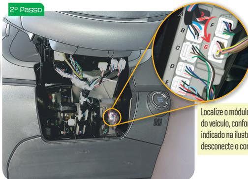
Localize o módulo original do veículo, conforme indicado na ilustração e desconecte o conector G.
