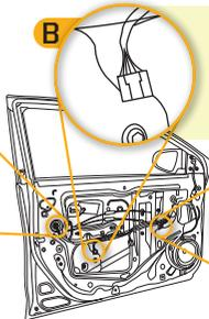
• Desconecte o sistema original fêmea do comando dos vidros elétricos e conecte as duas partes ao sistema "Y" fornecido com o produto (Conector fêmea do chicote original com o macho do produto e vice-versa).
