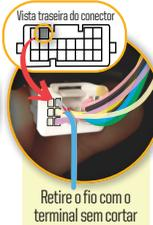
Retire o fio com o terminal sem cortar
