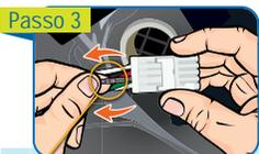
Após soltar as travas do terminal e do conector, retire o fio com o terminal (não corte o fio).
