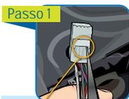
Solte o conector do motor do vidro do motorista, e com o auxílio de uma ferramenta de ponta fina desengate parcialmente a trava do conector.
